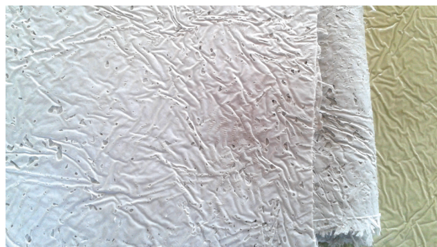
Rys. 3. Mata tworzywa SMC przed procesem termoutwardzania
